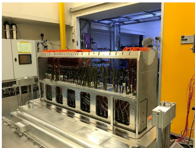
Imagen 1. Vista de la mitad del detector VELO antes de su envío al CERN (26 módulos).
