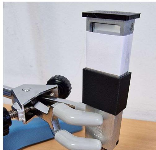
Figura 48. Absorción de partículas alfa al colocar un trozo de papel cubriendo parcialmente el sensor
