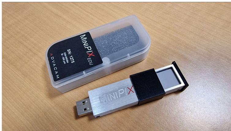
Figura 1. Detector MiniPIX con el sensor expuesto
