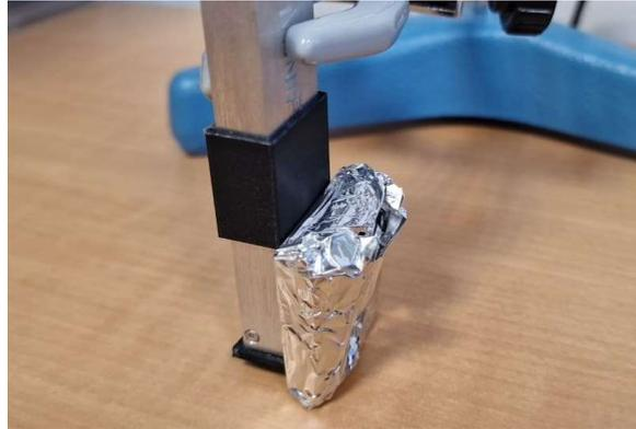
Figura 50. Primera capa de papel de aluminio (izquierda) y colocación de la muestra frente al detector
