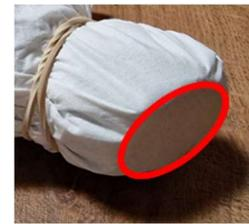
Figura 30. Colocación del filtro para aspirar aire del suelo y área del pañuelo que tendremos que colocar después de cara al detector para la medida
