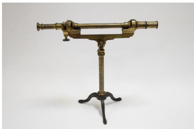
Figura 3. Sacarímetro da marca Duboscq-Soleil da colección histórica da Facultade de Física da USC. Fonte: Sisto e Losada, 2009, Historia da Física na Universidade de Santiago de Compostela.
