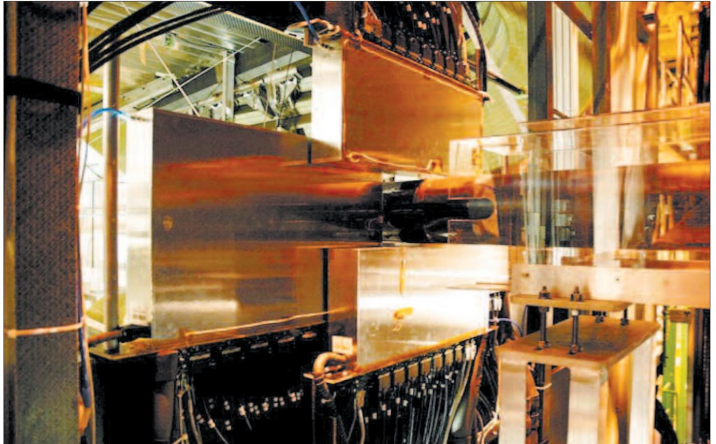
Fotografía de una de las tres estaciones de micropistas de Silicio del Inner Tracker de LHCb construido por la Universidad de Santiago de Compostela y la Universidad de Lausanne, tras su instalación en el LHC del CERN en 2009. El detector consta de 300.000 canales electrónicos. Puede verse en la foto el tubo horizontal del sistema de vacío del acelerador por donde circulan protones de energía de colisión 7 TeV
