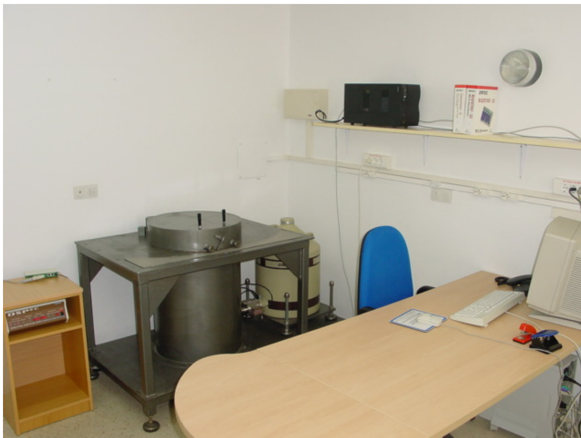
Figura 10: Equipo completo de espectrometría gamma utilizado en la medición de muestras de gas radón tomadas con sondas de carbón activo.
