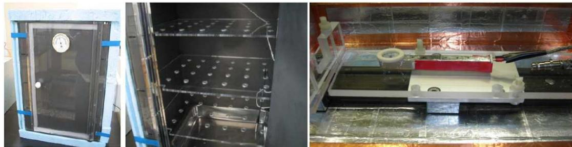
Figura 3.3: Cajas para a)-b) control de humedad y c) aislamiento eléctrico.
