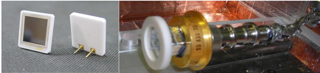
Figura 3.2: Fotodiodos utilizados en este experimento a) S8664-1010 de Hamamatsu b) SD630-70-73-500 de Advanced Photonix Inc.
