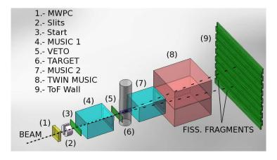
Figura 4: Sistema de detección usado en este experimento.
