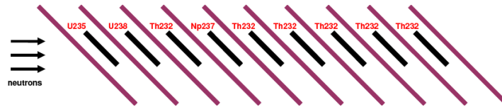
Figura 3: Vista esquemática del dispositivo experimental con diez detectores PPAC y nueve blancos intercalados entre ellos. Todos los elementos se encuentran rotados 45^\circ para lograr una mayor aceptación en el ángulo polar \theta con respecto a la dirección del haz.
