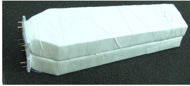
Figura 5.2: Detalle de dos cristales del protoZero recubiertos.
