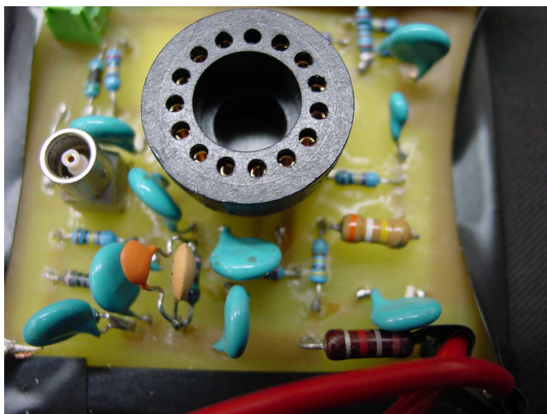
Figura 4.7: Foto de la base del fotomultiplicador XP3102.
