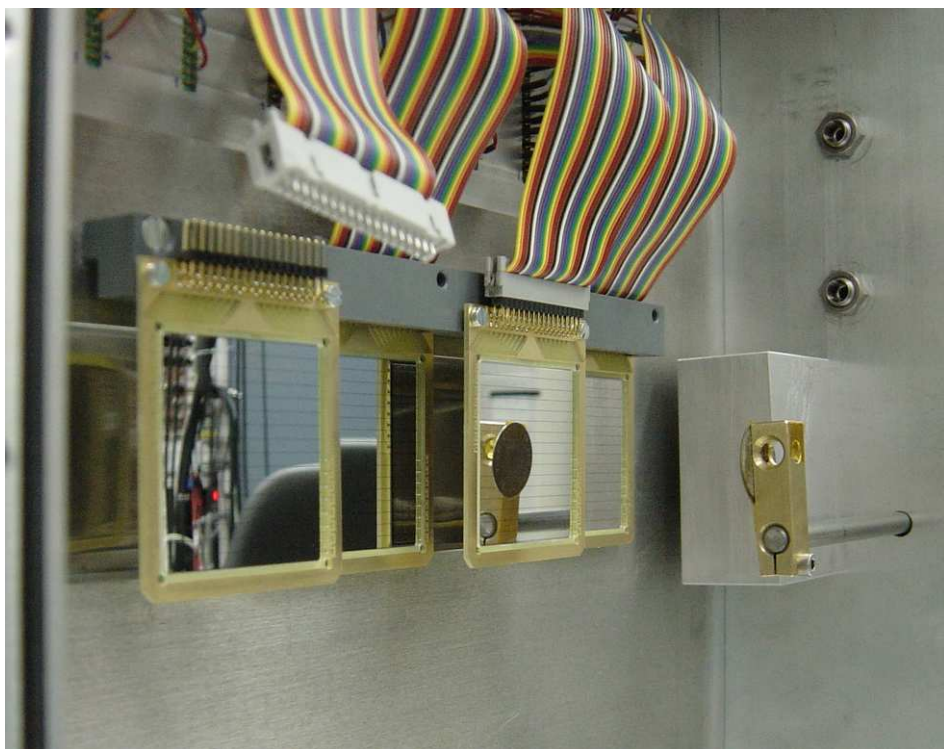
Figura 4.2: En esta figura podemos ver los cuatro detectores de Silicio colocados en sus posiciones dentro de la cámara de vacío. En la parte superior de la figura se pueden observar los cables twisted-pair que van directamente a los preamplificadores situados en la parte externa de la cámara de vacío. Se puede observar también a la derecha de la imagen la fuente \alpha para la calibración de la respuesta en energía de los detectores (pastilla circular reflejada en uno de los detectores). Se trata de una fuente triple combinada de ^{239}\text{Pu} , ^{241}\text{Am} y ^{244}\text{Cm} . La fuente está colocada sobre una barra móvil que permite colocarla delante de cualquiera de los cuatro detectores.
